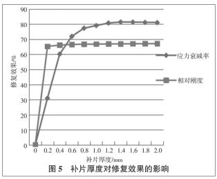
对刚度为 67.03%。补片厚度继续增加,虽然相对刚度的数值还在提高,应力衰减率开始缓慢地下降。由于随着补片直径的增加,修补区域的局部刚度增加;随着补片厚度的增加,修补区域的刚度亦会增加,因此,补片厚度的优化会对补片直径的优化结果产生积极影响。故补片厚度的最优值为 1.4 mm。
