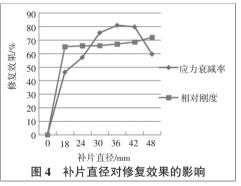
由表 2 和图 4 可知, 当补片的直径为 1.5 倍的损伤孔 直径时,复合材料层合板胶结修补结构的应力衰减率达 到了46.21%,相对刚度为65.01%。由此证明,使用复合材 料层合板胶结修理受损结构, 能够有效地提高铝合金板 结构的强度,在一定程度上恢复受损结构的刚度。
