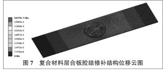
通过图 6 可以观察到铝合金板和复合材料补片的应力大小;通过图 7 可以观察到铝合金板和复合材料补片的变形,随着载荷的增加,变形增加。
