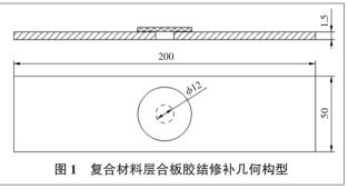
图 1 中, 母板为铝合金板, 其外形尺寸为 200 mm×50 mm×1.5 mm, 中心损伤孔直径 D=12 mm, 为中心对称结构。铝合金板的边界条件为: 一边为固支, 另一边受压力载荷 P=10 Pa。以复合材料层合板补片的直径 d 和厚度 t 为研究变量,来分析复合材料层合板胶结修理的可靠性。
